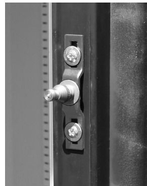
фото 1 Установка ригеля на остальные холодильники
