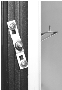
Установка ригеля на POLAIR 1200
